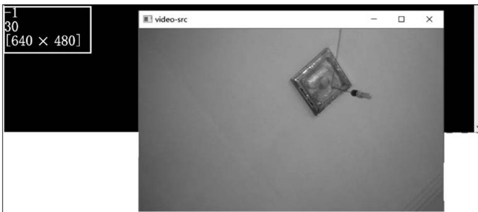
图 5-24 使用 OpenCV 4 读取并显示摄像头
