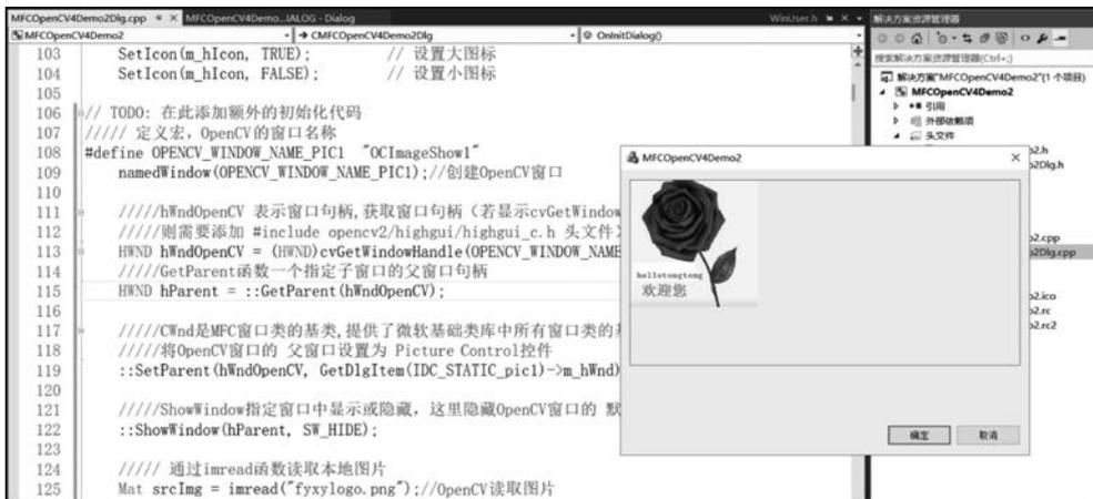
图 5-35 将 OpenCV 窗口嵌入 MFC 控件上
