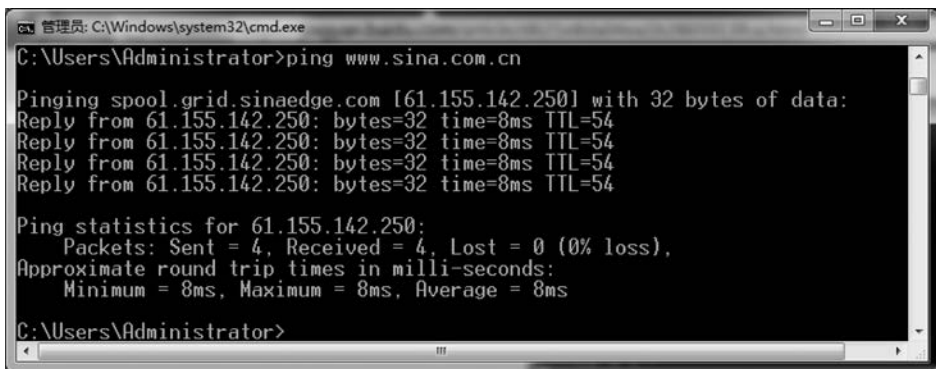
图 5-4 使用 PING 命令来探测目标主机是否处于运行状态
