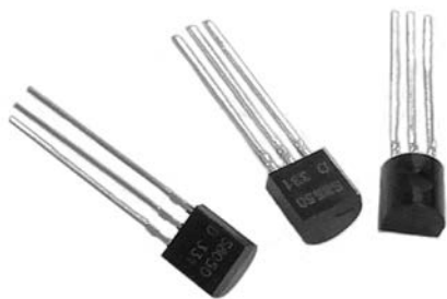
图 5-28 小功率三极管元件
