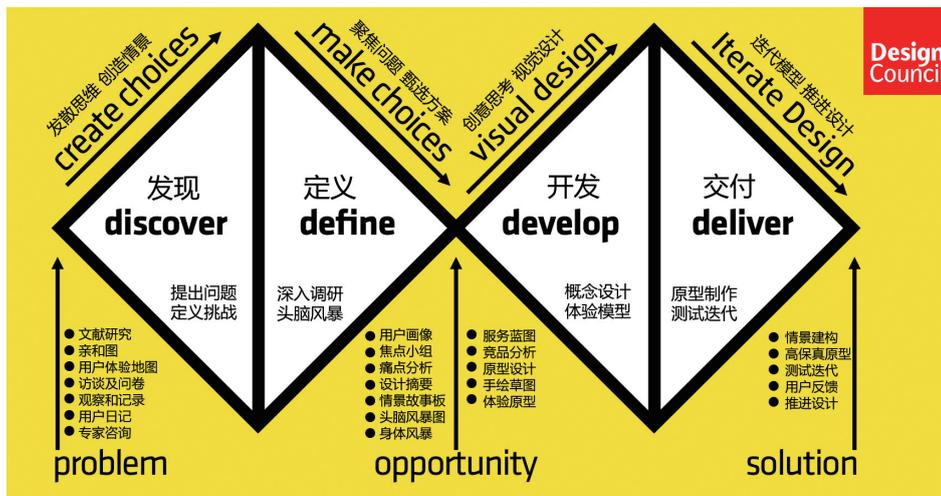
图 3-1 英国设计委员会提出的“双钻石设计流程图”
