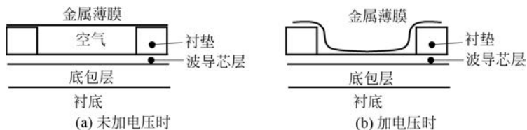
图 5.41 金属薄膜光开关的结构
