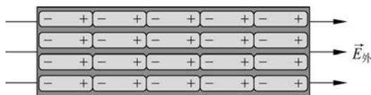
图 3.30 非极性电介质极化过程示意图
