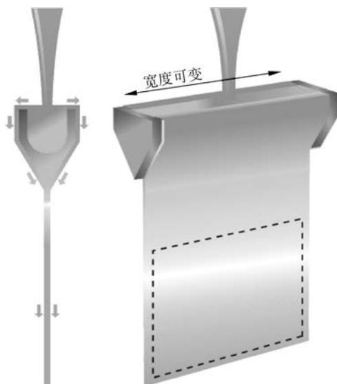
图 3.36 溢流融流法制备玻璃示意图
