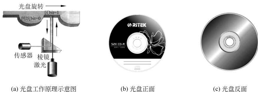
图 3-16 光盘工作原理示意图以及光盘成品
