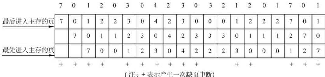
图 5-36 FIFO 置换算法主存中页面变化示意图
