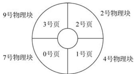
图 5-49 采用时钟置换算法
