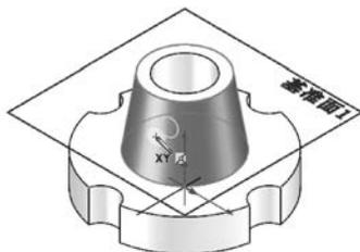
图 5-39 在支座侧面设定孔的圆心位置
