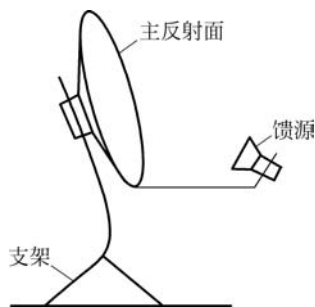
图 3.21 偏置型抛物面天线
