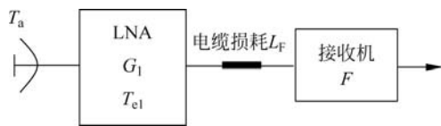
图 3.59 卫星通信接收系统简化框图
