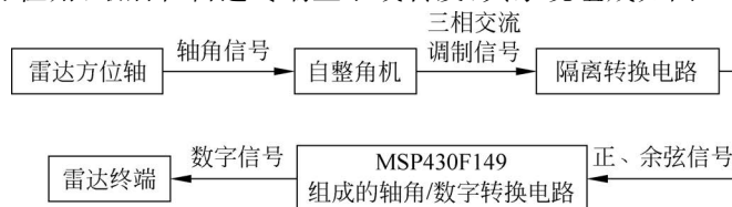
图 3-16 雷达方位角测量系统组成
