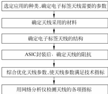
图 3-2 RFID 电子标签天线的设计步骤
