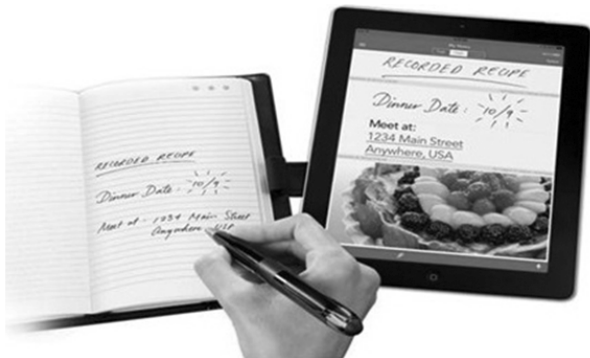
图 3-15 写在纸面上的墨水笔画,其数据被无线传输给计算机
