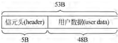
图 3-5 ATM 信元结构
