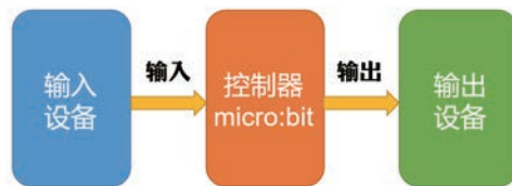
图3-1 micro:bit智能硬件系统组成
