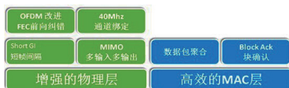
图 2-2 802.11n 的物理层与 MAC 层模型
