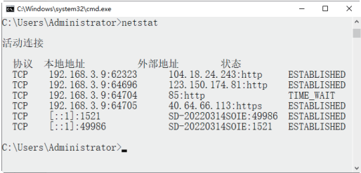
图 2-33 查看服务器活动的 TCP/IP 连接
