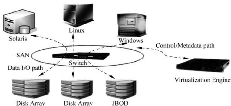
图 5.2 SAN 系统结构示意图
