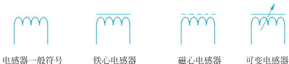
图 3-3 电感器的图形符号
