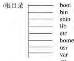
图 3-2 Linux 系统的部分主要目录结构
