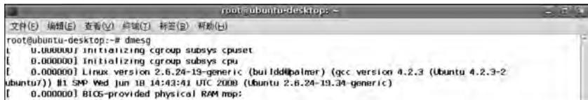
图 3-1 执行命令 `dmesg` 后显示的部分内容
