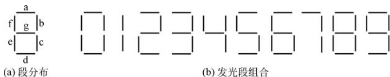
图 3.35 七段字符显示器及显示的数字
