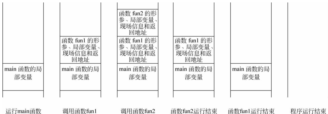
图 5.10 函数调用时“栈”空间的分配和释放
