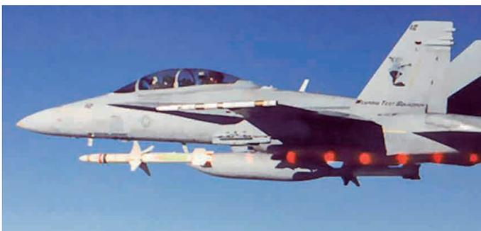
发射瞬间的“哈姆”高速反辐射导弹
