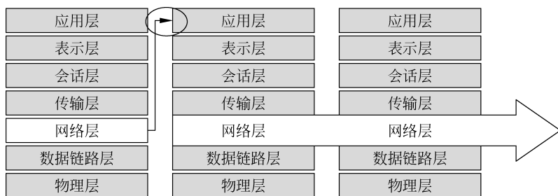
图 5-8 电路层网关防火墙
