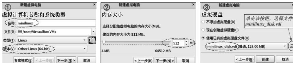
图 3.1 在 VirtualBox 中安装极简版 Linux 发行版
