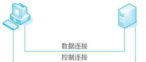
图 5.1 FTP 的工作流程
