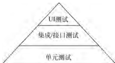
图 3-11 分层测试的“金字塔”模型
