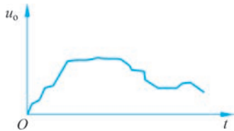
图 5.1.1 直接耦合放大电路的零点漂移
