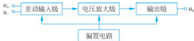
图 5.1.2 集成运放的内部基本结构示意图
