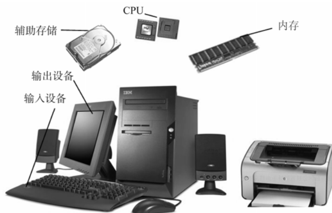
图 1.2 计算机硬件系统基本组成
