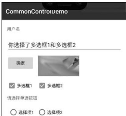
图 3.11 CheckBox 和 RadioButton 运行效果
