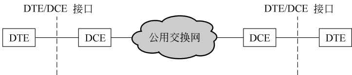
图 5-1 DTE 与 DCE 的连接示意图
