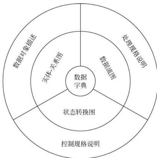
图 5-6 结构化分析模型
