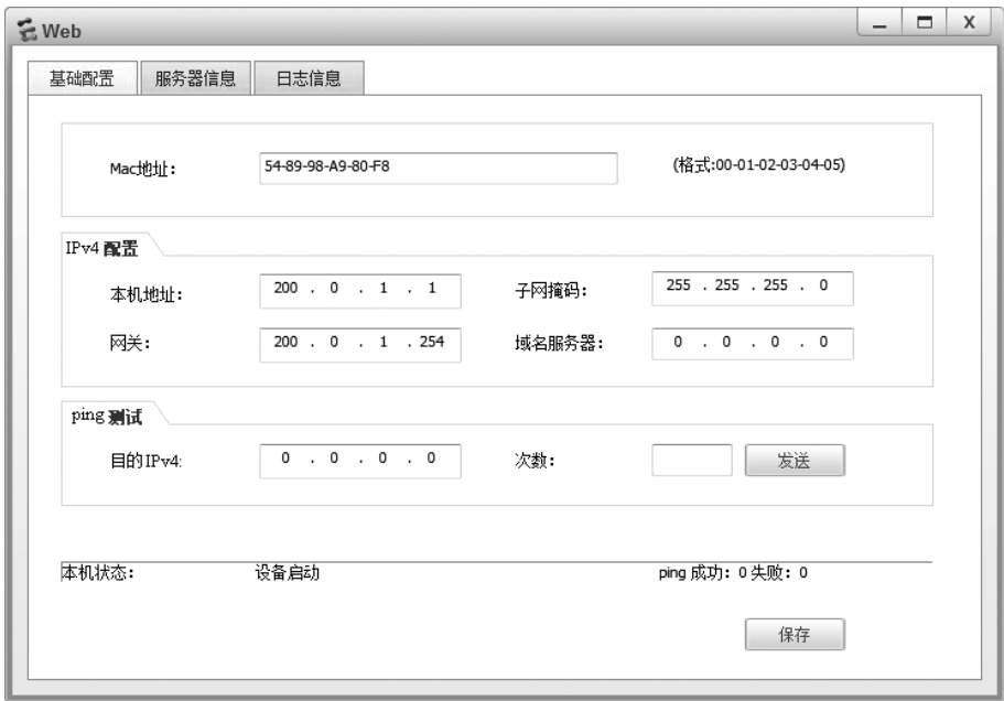
图 3.32 Web Server3 的基础配置界面
