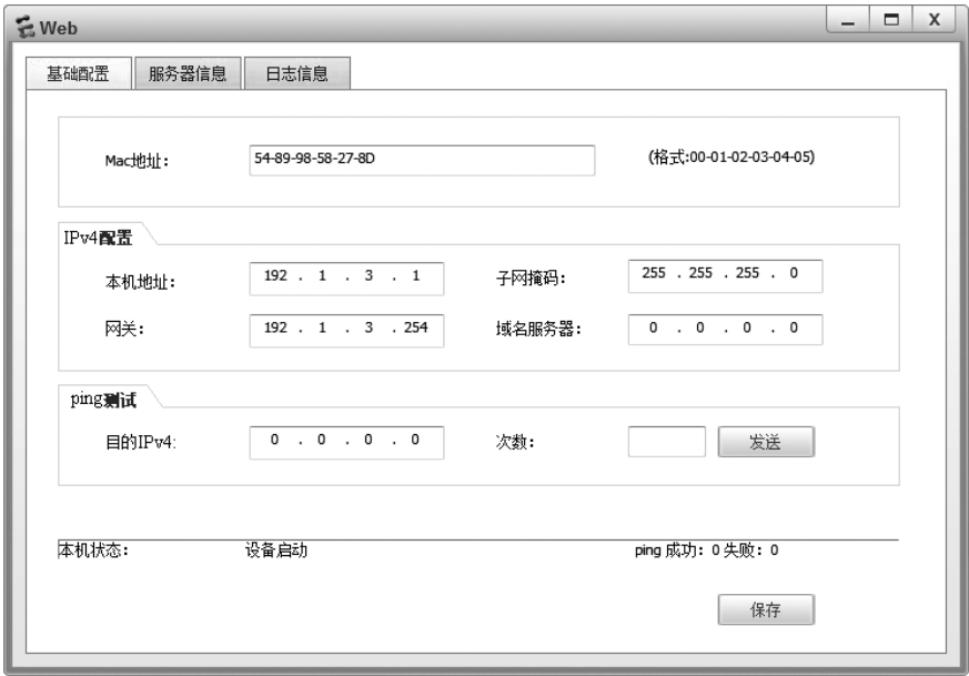
图 3.31 Web Server2 的基础配置界面
