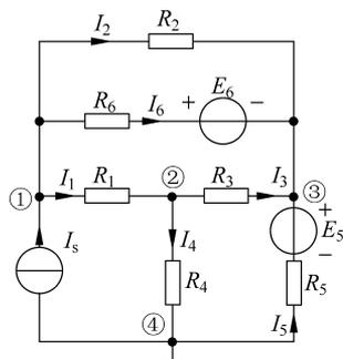
图 3-13 建立节点法方程的用图
