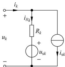
图 3-3 电路中的一条典型支路
