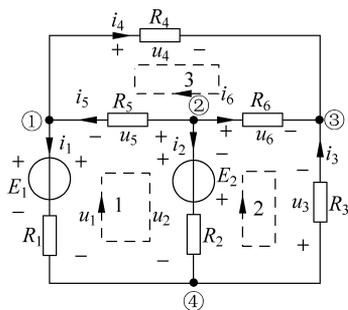
图 3-7 建立支路电流法方程的用图
