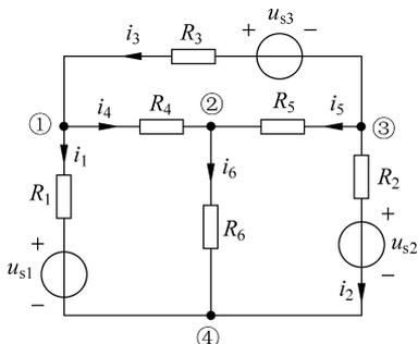
图 3-1 说明独立节点、独立回路的电路
