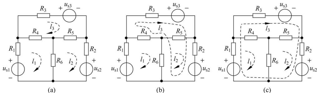
图 3-2 图 3-1 电路的三组独立回路示意
