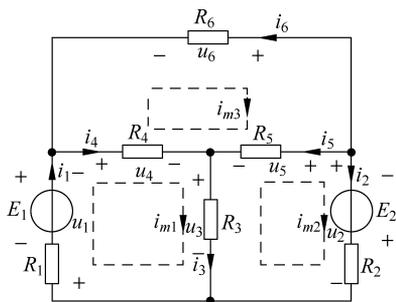
图 3-20 建立网孔法方程的一个电路
