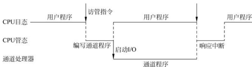
图 5-27 CPU 和通道执行程序的时间关系
