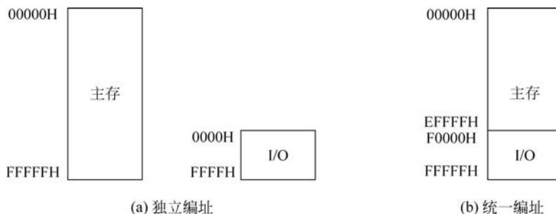
图 5-3 I/O 端口的编址方式
