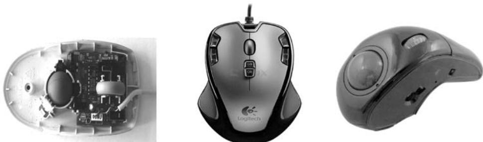
图 3-19 机械式、光电式、轨迹球式鼠标
