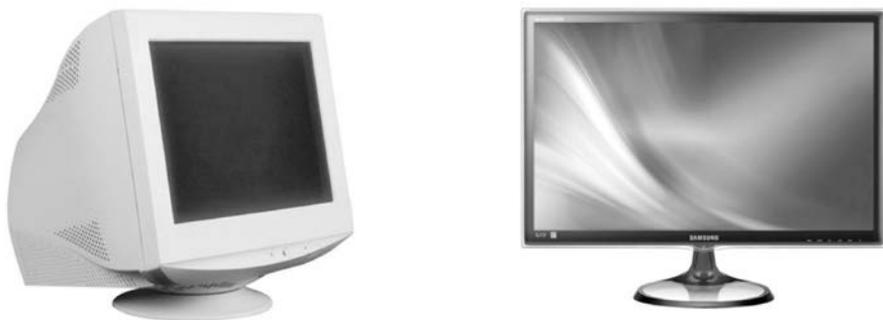
图 3-21 CRT 显示器和 LCD 显示器
