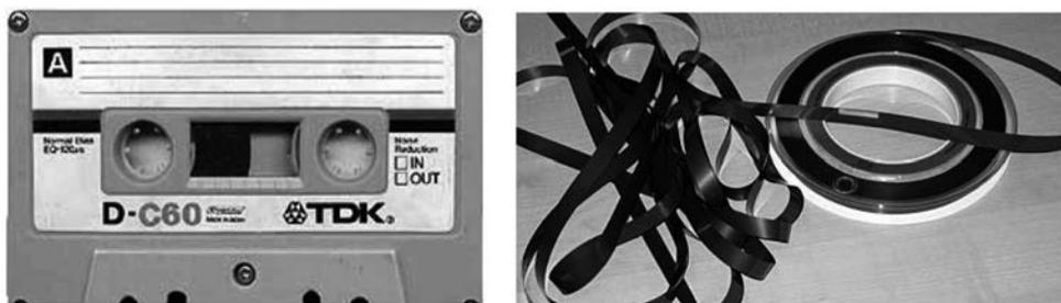
图 3-10 磁带存储器
