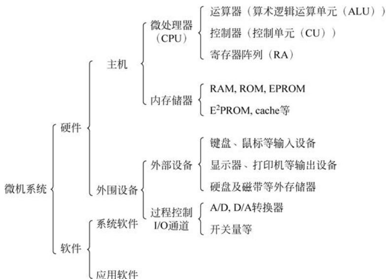
图 3-5 微型计算机系统组成
