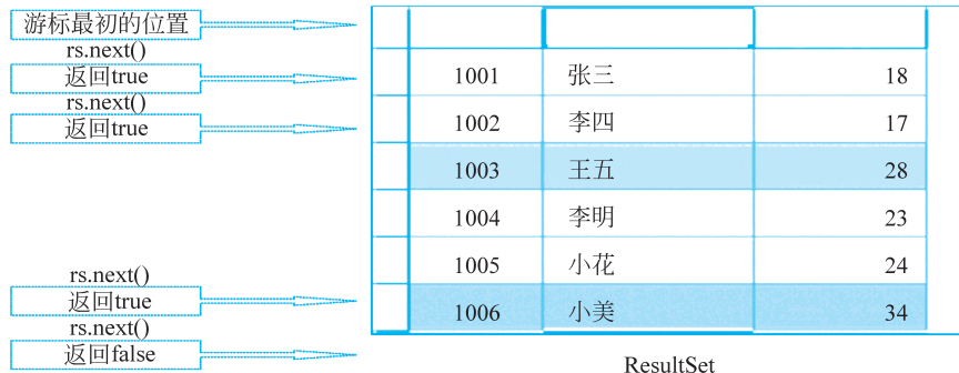
图 3-5 游标的工作原理
