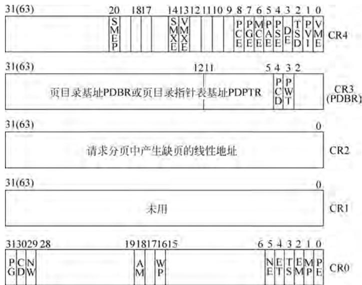
图 5-43 5 个控制寄存器的结构
