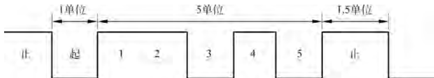
图 5-9 起止式插入同步码组
