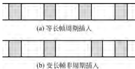
图 5-11 连贯式插值帧同步码组
