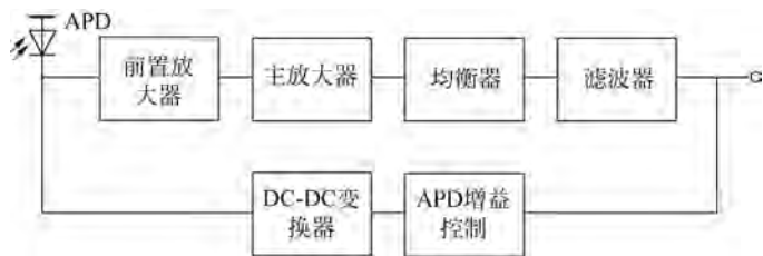
图 5-58 APD 光接收机原理方框图
