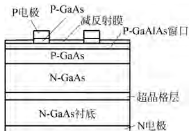
图 5-12 GaAs/AlGaAs 太阳能电池的构造
