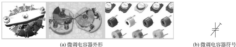
图 3-9 微调电容器外形及符号
