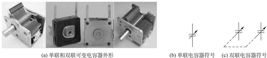
图 3-10 单联电容器、双联电容器外形及符号
