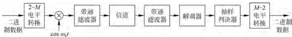
图 5-37 M 进制幅度调制系统原理框图
