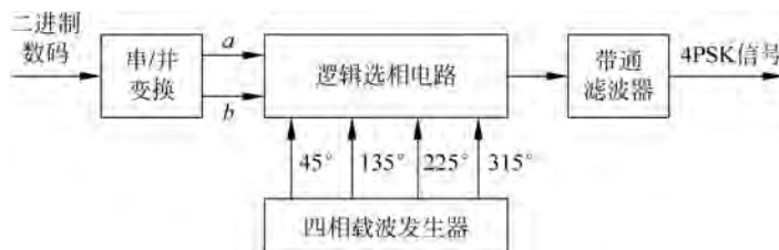
图 5-41 相位选择法产生 4PSK 信号(B 方式)原理框图
