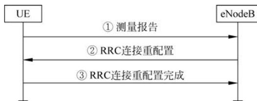
图 5-32 站内小区切换信令流程
