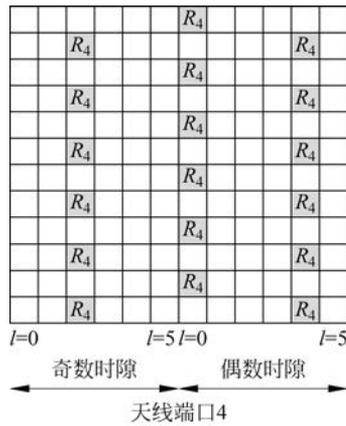
图 5-20  $\Delta f = 15\text{kHz}$  时 MBSFN 参考信号
