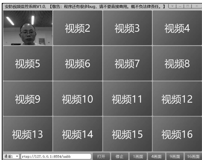
图 5-5 基于 Qt 和 FFmpeg 的视频监控客户端
