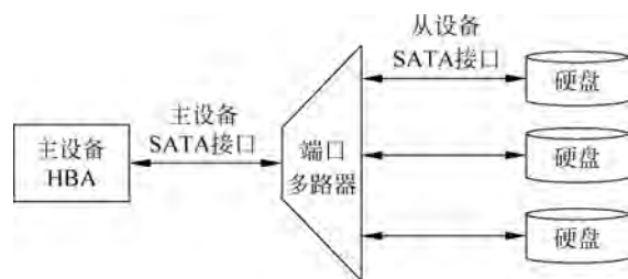
图 5-24 SATA 总线一对多连接方式
