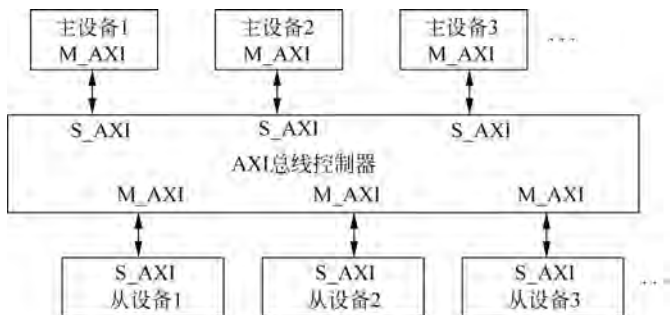
图 5-14 AXI 总线多个主、从设备互联拓扑
