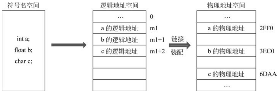
图 5-7 静态地址重定位示意图
