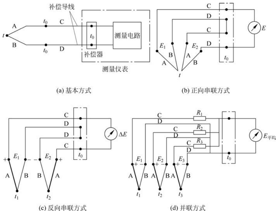
图 3-19 热电偶测温回路的 4 种连接方式
