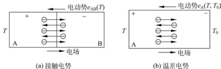
图 3-7 热电偶热电势的形成
