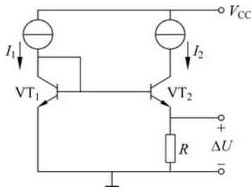
图 3-27 集成温度传感器的工作原理图
