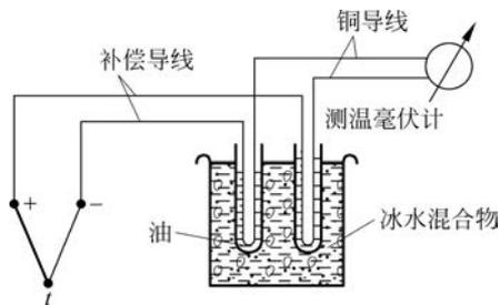
图 3-13 热电偶冷端冰点恒温法
