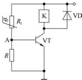
图 3-26 热电式继电器保护电路
