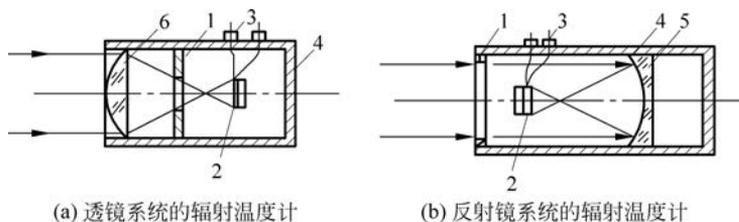
图 3-33 透镜式和反射镜式系统的示意图
