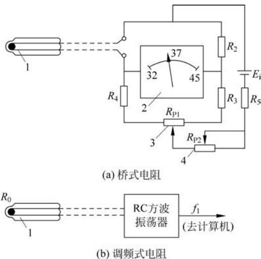
图 3-25 热敏电阻温度计原理图
