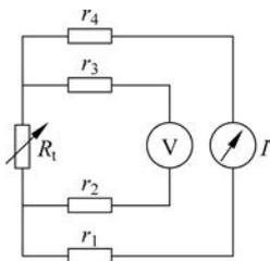
图 3-22 热电阻四线制接法
