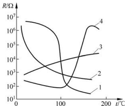
图 3-23 各种热敏电阻的特性曲线
