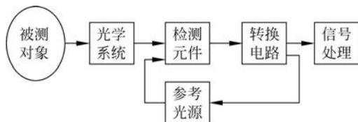
图 3-32 辐射式测温仪表组成框图
