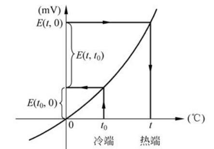
图 3-14 冷端温度的计算修正曲线
