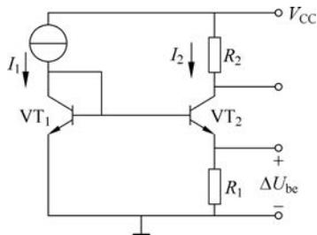
图 3-28 电压输出型温度传感器的原理图
