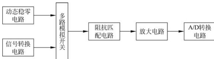
图 3-37 前向通道电路原理框图
