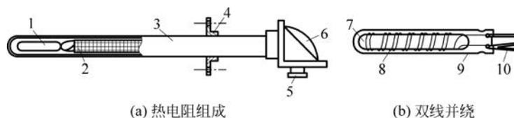
图 3-20 普通型热电阻的结构
