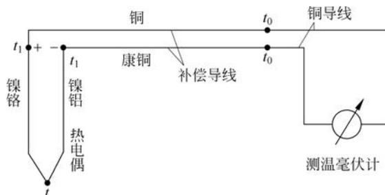
图 3-12 补偿导线结构及其接线图
