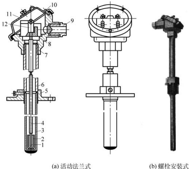
图 3-16 装配式热电偶结构
