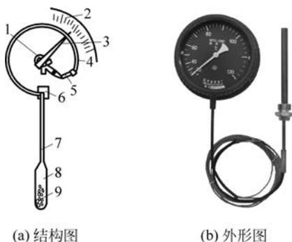
图 3-5 压力式温度计
