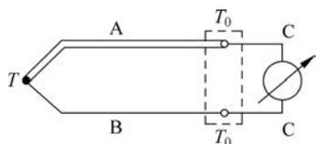
图 3-9 接入第三种导体的热电偶
