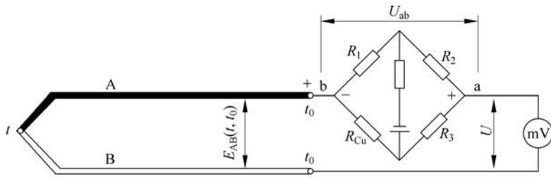
图 3-15 冷端温度补偿电桥原理
