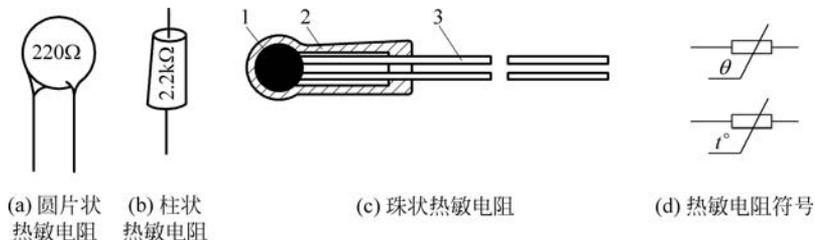
图 3-24 热敏电阻的结构外形及符号
