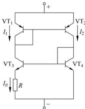
图 3-29 电流输出型温度传感器原理图
