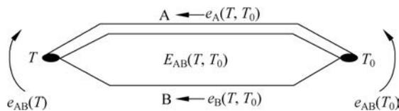
图 3-8 热电偶的总热电势大小和方向
