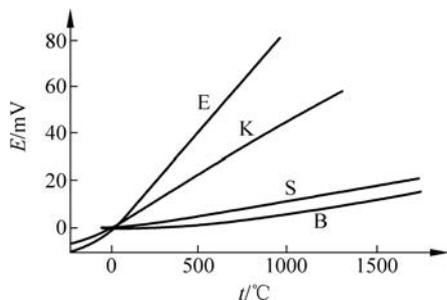
图 3-11 热电偶的热电特性曲线
