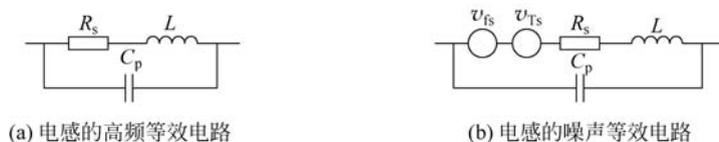
图 3.14 电感的高频等效电路和噪声等效电路
