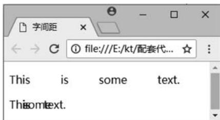
图 5.8 word-spacing 设置正值、负值效果
