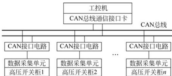
图 5-18 高压开关柜在线检测系统结构图
