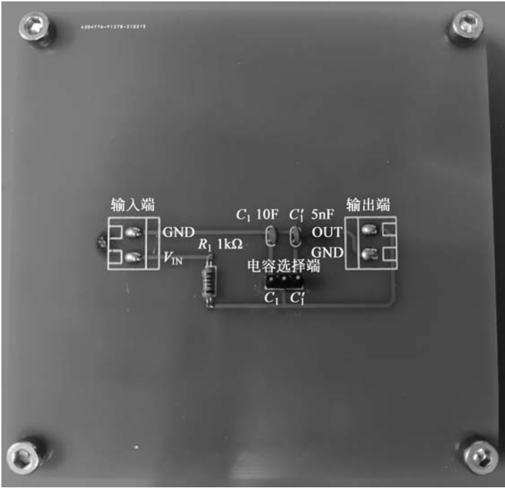
图 5.5 RC 积分电路板
